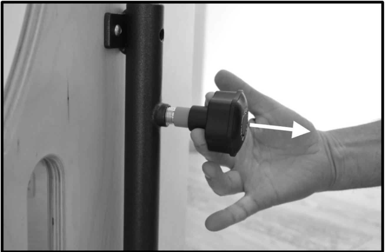
Regolare la maniglia all'altezza desiderata aiutandosi nel posizionamento del blocco osservando che il foro posto sul fodero della maniglia collimi con uno dei fori posti sulla maniglia (vedi foto sotto). Al termine dell'operazione ruotare in senso orario i due pomelli per serrare la maniglia nella nuova posizione.
