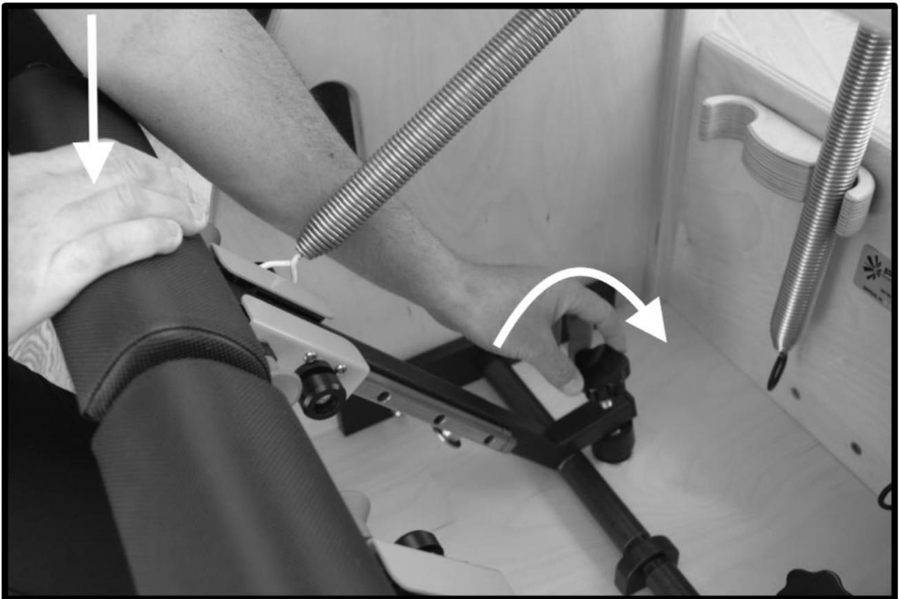
La stessa operazione può essere compiuta con i pedali che lavorano in maniera indipendente, sfilando il bastone in faggio che permette di farli lavorare congiuntamente, e regolando i due pedali in maniera indipendente mediante i due pomelli come in figura.
