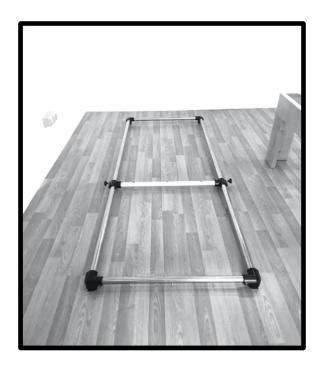
Allentare parzialmente i fermi a vite posti sulle quattro piastre di supporto nere, presenti sui quattro angoli della struttura in legno, rimuovere quindi definitivamente i quattro tubi verticali utilizzati per il trasporto.
